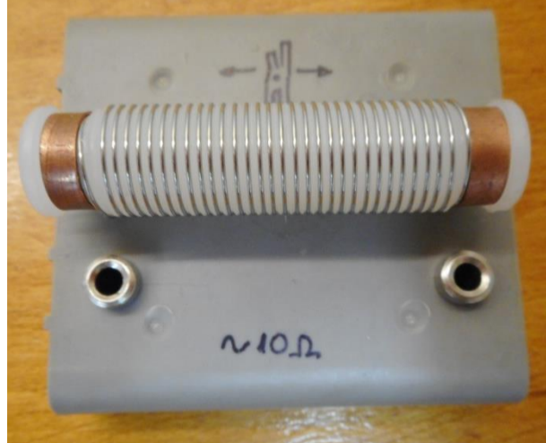
3 db ellenállás: 10 Ω, 20 Ω és 50 Ω
