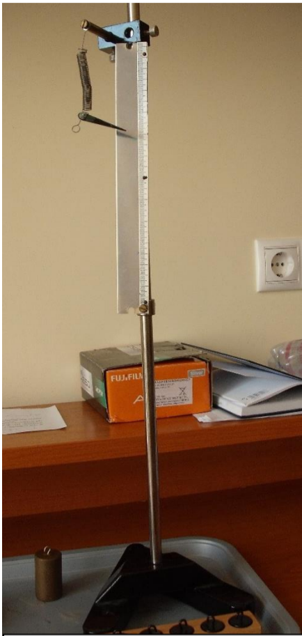
tükörskálás állvány mutatóval
